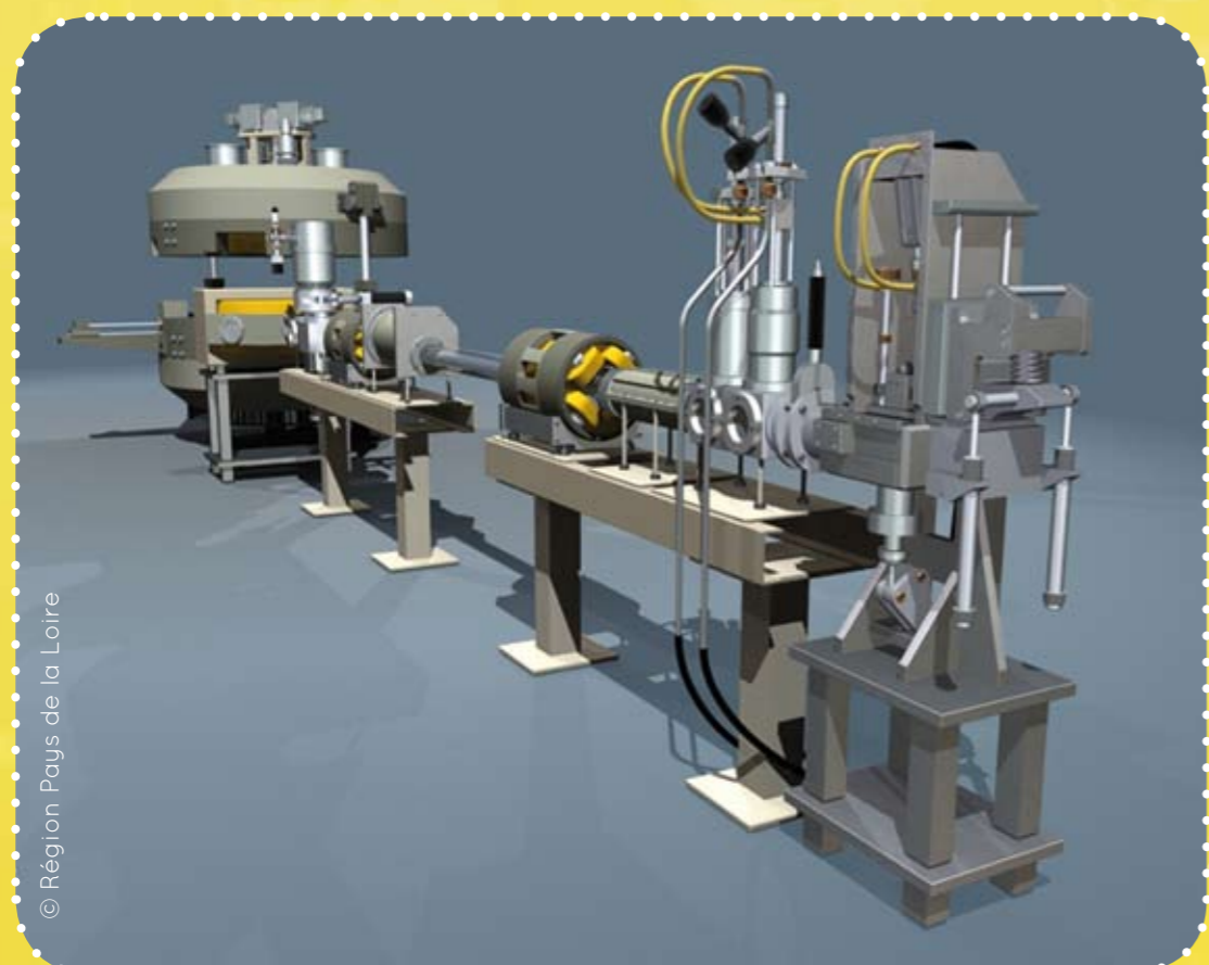
L'accélérateur ARRONAX et une ligne de faisceau de particules pour produire des atomes radioactifs à usage médical.
