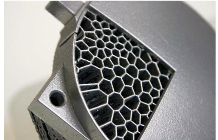
Pour obtenir ces pièces métalliques ultra légères, l'équipe d'ingénieurs révèle avoir utilisé un système d'impression 3D SLM (Selective Laser Melting), combiné à une conception moins dense comprenant des structures stochastiques et symétriques. Côté matériaux, le choix s'est porté sur trois alliages d'aluminium : AlSi12, AlSi40 et Al6061.
