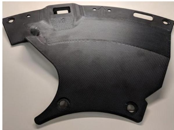
Le matériau thermoplastique Antero de Stratasys a permis de fabriquer une pièce déterminante située à l'extérieur de la trappe d'accueil d'Orion. Il s'agit d'une pièce complexe constituée de six composants imprimés en 3D et encastrés ensemble pour former un anneau à l'extérieur du vaisseau.
