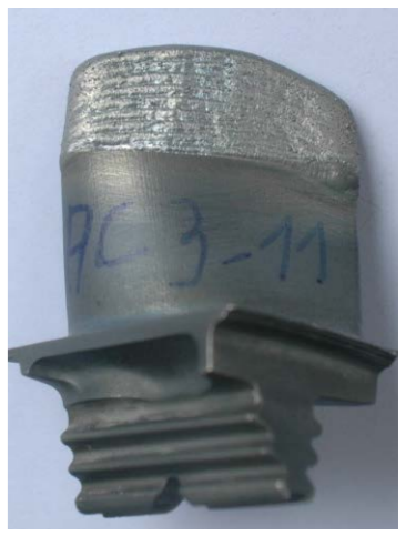
Réparation sommet Aube en MC2 (monocrystal)
