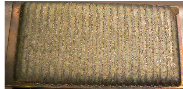
Dépôt TRIBALLOY700 / Inox (utilisation d'un préchauffage à 500°C)
