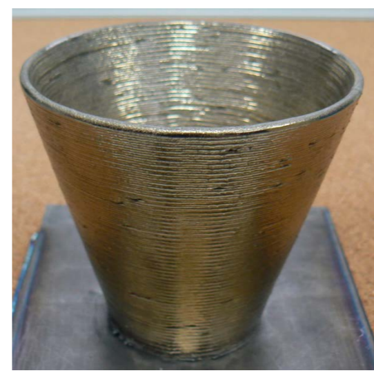
Pièce composite à matrice titane (TA6V + 3% B 4 C)
