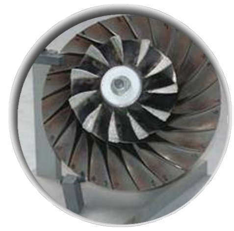
Rehausse compresseur TA6V - Recalage 3D
