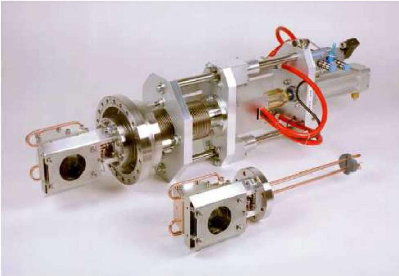
Cage de Faraday et bloc d'arrêt de 25 KW. Linac de GSI. (Bride 150 mm<sup>2</sup>)
