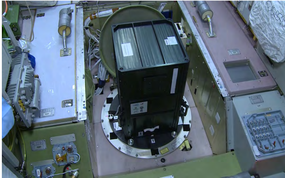
Fig. 1 : MINI-EUSO en position de « run », devant le hublot de quartz du module Zvezda de l'ISS.
