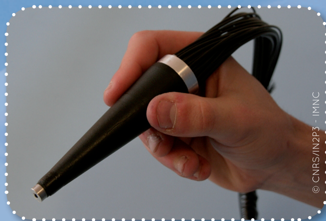
Couplage entre la mini sonde « TRIOP » et l'outil chirurgical (aspirateur ultrasonore) pour les tumeurs cérébrales.
