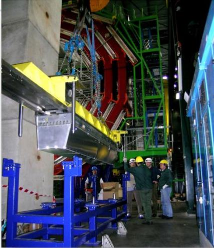
2- le support est fixé sur la **cage cylindrique** **rq:** travail important d'alignement en amont de l'outillage
