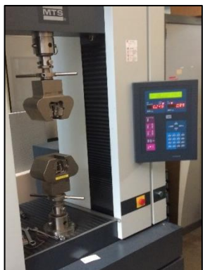
Machine de traction MTS-30M de 150 kN
