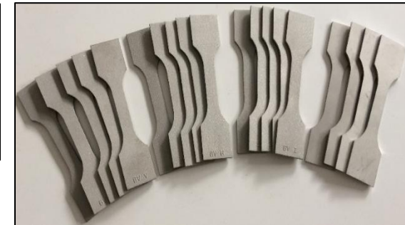
4 séries d'éprouvettes 0°, 45°, 90° et témoins J. Laurence (CPPM), A. Gonnin (LAL), BV Proto
