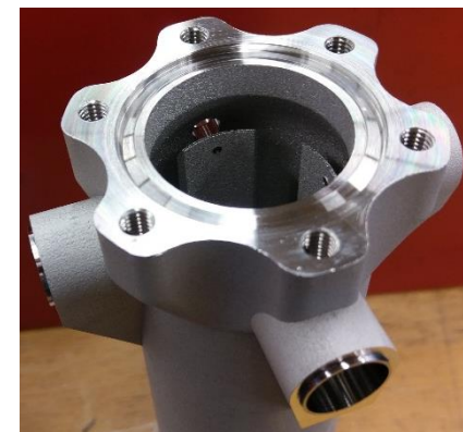
BPM Stripline après usinage
