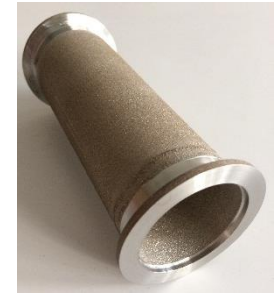
Tube DN40KF après usinage
