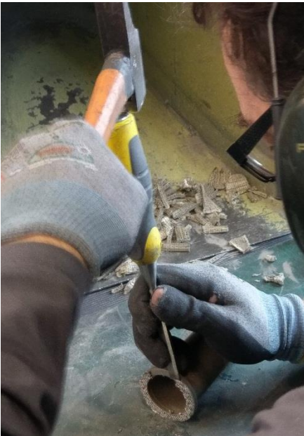
Enlèvement des supports
