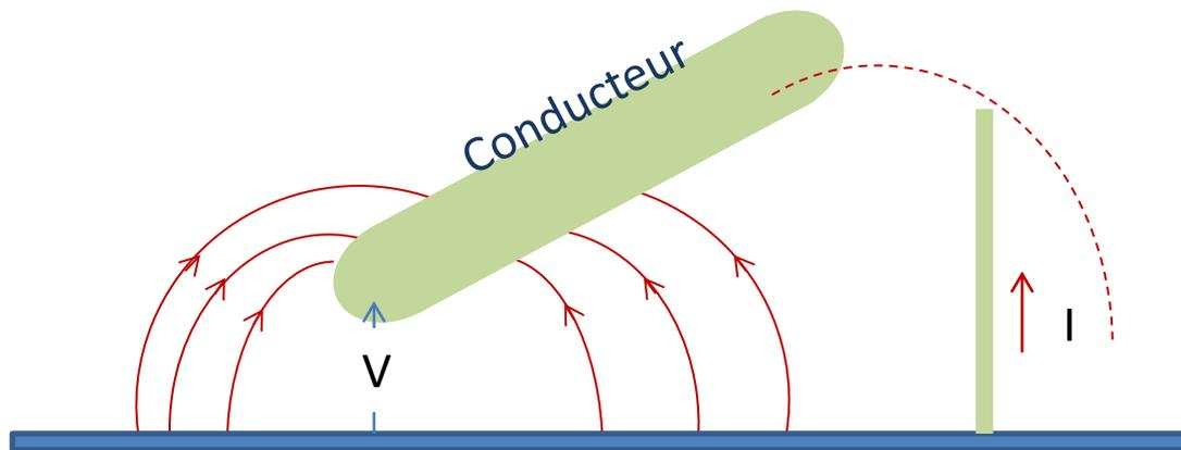
C'est le principe de fonctionnement d'une antenne en réception.
