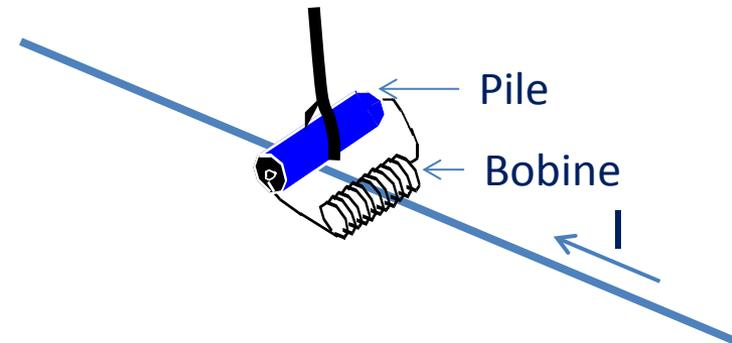
Un courant  $I$  parcourant un conducteur engendre un champ magnétique  $H$  exprimé en **A/m** ou en **Tesla** ( $1\text{A/m} \sim 1,25\mu\text{T}$ ).
