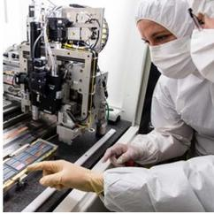
mètre carré, assemblés en presque 500 circuits intégrés, collés sur les deux faces de 10 demi-disques, le tout monté dans un tonneau de 4 mètres de long et qui doit être positionné dans l'expérience ALICE au dixième de millimètre près. [Lire la suite](#) sur le site de l'IRFU.
