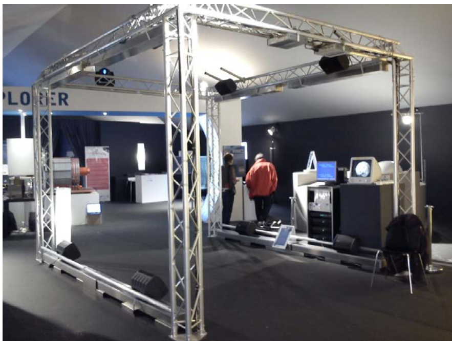
Configuration du Cosmophone à 8 canaux proposé pour l'installation dans l'option avec pont mobile autonome
