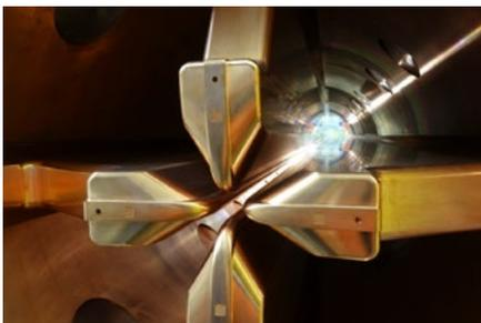
Vue interne du quadrupole radiofréquence (RFQ) à 4 vanes de SPIRAL2 au GANIL pour l'accélération et la mise en paquets temporels du faisceau. © R. Ferdinand
