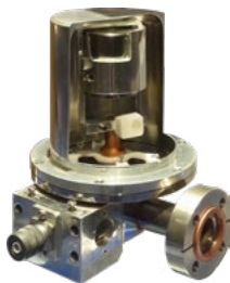
Vue de l'intérieur d'un spectromètre gamma avec son cristal de Germanium après découpe du capot en aluminium. © Photothèque IN2P3/CNRS
