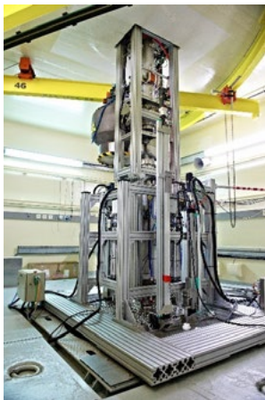
Couplage du réacteur VENUS-F (SCK CEN) avec l'accélérateur GENEPI-3C (CNRS) pour les expériences sur maquette d'ADS. © SCK CEN
