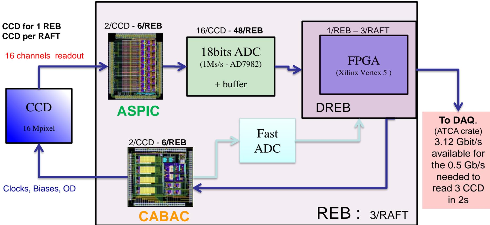
**ASPIC** a pour fonction d'amplifier les signaux analogiques provenant des 16 sorties de chaque CCD
