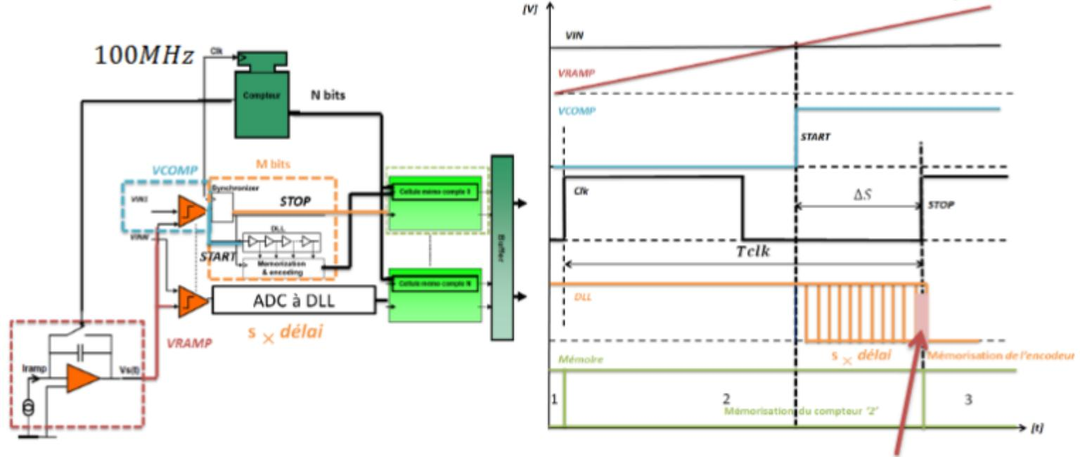
$T_{conversion} \times F_{DLL} = 2,56 \mu s \times 3,2GHz = 8192$  soit **13 bits**
