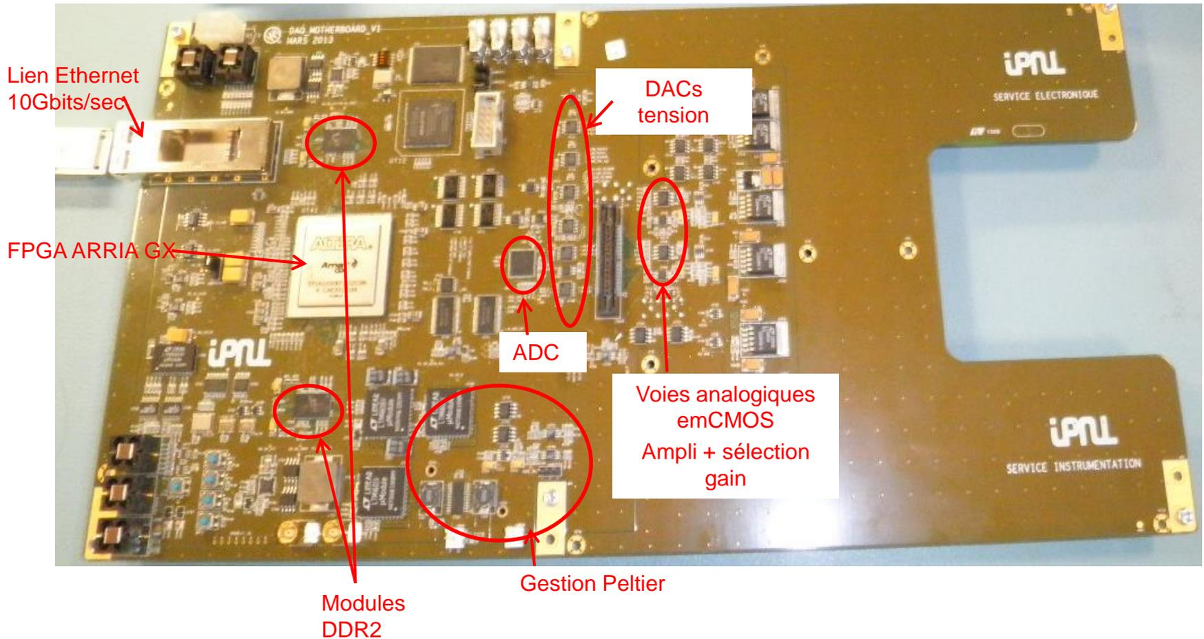
FAZIA est un multidétecteur de nouvelle génération pour les particules chargées, prévu pour servir dans le domaine des collisions d'ions lourds autour et au-dessous de l'énergie de Fermi (10-100 MeV par nucléon).
