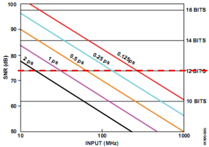
SNR (dB) max. théorique pour un ADC à N bits (bruit de quantification):
