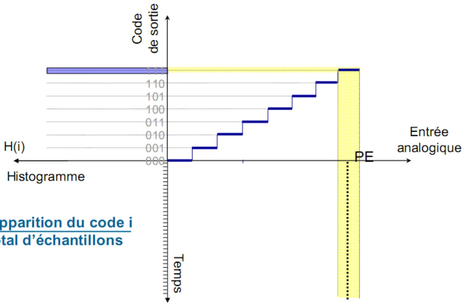
$$H(i) = \frac{\text{nbr d'apparition du code } i}{\text{nbr total d'échantillons}}$$
