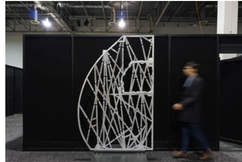
Paroi Airbus A320 optimisée par design génératif Autodesk
