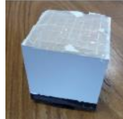
PM + blocs BGO striés reconditionnés (LPC)
