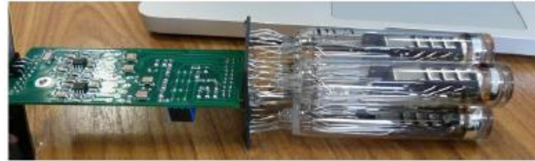
PM + blocs BGO striés reconditionnés (LPC)
