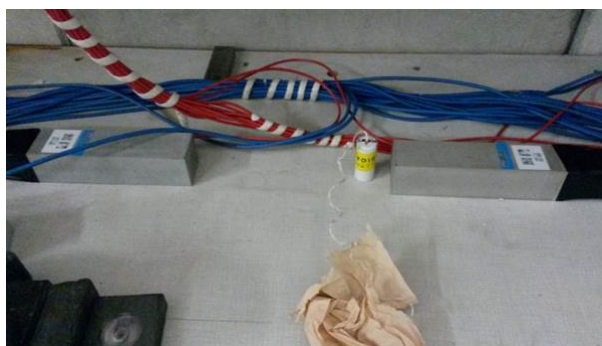
FIGURE 2.1 – Une source radioactive d’Americium-Beryllium (que l’on va définir dans la section suivante), en jaune, entourée de plomb (le tout faisant 2.5 cm), émet des rayonnements gammas et des neutrons. Deux détecteurs (deux "phoswich") sont placés de part et d’autre de cette source. Le premier phoswich (à droite avec en plus une sélection en énergie de 4.43 MeV) est placé à 3 cm de la source et le second (à gauche) est placé à 24.5 cm de la source.
