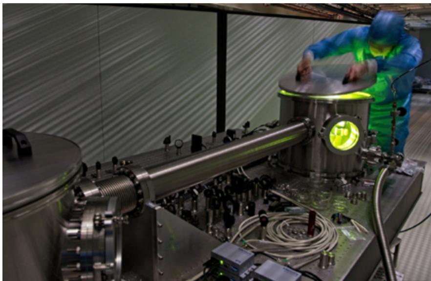
Banc de mesure sous vide pour caractériser les miroirs d'Advanced Virgo au LMA.
