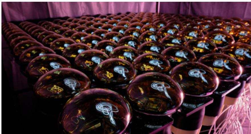
Dispositif de test du système électronique de numérisation des signaux associé aux photomultiplicateurs du détecteur JUNA par le LP2i Bordeaux. © Jean-Joue
